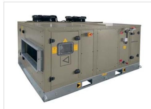
AIRPLUS Çatı Tipi Paket Klima Santralleri, soğutma ve heat pump la (ısı pompalı) ısıtma yapacak şekilde tasarlanmıştır. Bunun dışında ısıtma için ayrıca projeye bağlı olarak içerisinde; sıcak su baryası, elektrikli ısıtıcı veya doğalgaz yakıtlı sıcak hava üreticisi yerleştirilebilir. Tek gövdede tamamıyla montajı tamamlanmış ve R410A soğutma gazı ile şarjı yapılmış olarak sevk edilen çatı tipi paket klima santralleri, müşteriye büyük montaj kolaylığı sağlamamaktadır.
