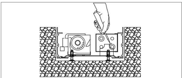
8. Tesisat su ile doldurulduktan sonra çalıştırılır. Batarya girişindeki purjörden tesisattaki hava tahliye edilir.
