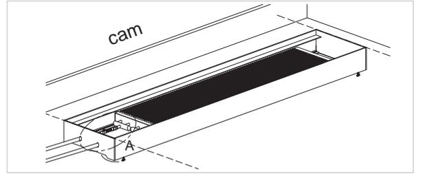
4. Hidrolik bağlantılarını ve fanlı ise elektriksel bağlantılarını yapınız. Beton şap dökülmeden önce tüm bağlantıları kontrol ediniz.
