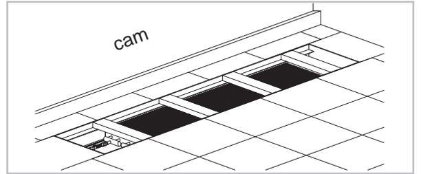
7. İnşaat artıklarının konvektör içersine girmesini engellemek için kasaya seperatör yerleştirin. Beton şap ile kasa etrafını doldurun.
