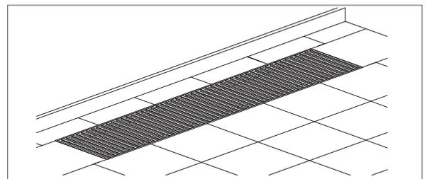
9. Beton kuruduktan sonra ara tutucu takozlar çıkartılır ve lineer menfez serilir.
