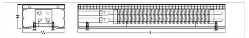
Doğal konveksiyonlu yer konvektörleri, doğal hava konveksiyonu prensibine göre çalışan konvektörlerdir. Mahal ısıtmasında ikincil olarak kullanılır. Cam yüzeyinde oluşacak ısı kaybını önlemek ve özellikle buğulanmayı ortadan kaldırmak için kullanılırlar.
